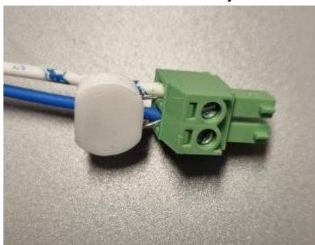
Voorbeeld: Afsluitweerstand aan USB zijde
